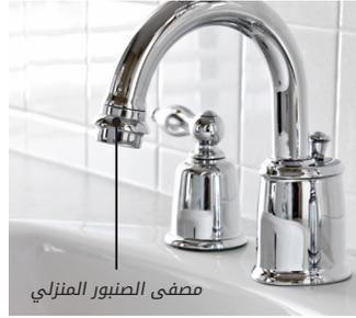
تستخدم أجهزة التنقية في صنابير المياه لتوفير تدفق مستمر للمياه من الصنوبر بضغط ثابت بحيث تمنع رش الماء و بالتالي تقلل من استهلاك الماء. اجهزة تصفية الصنابير تحتوي بالعادة على شبكة و على جلدة. الشبكة قد يتسخ
