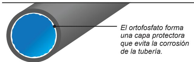
El ortofosfato forma una capa protectora que evita la corrosión de la tubería.
