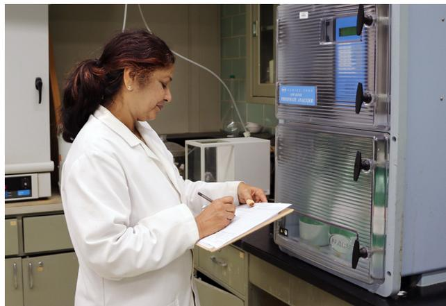
La dosificación de ortofosfato se mantiene bajo constante monitoreo en cada planta tratadora de agua de la GLWA mediante el uso de un analizador en línea. La exactitud del medidor la revisa un químico con una frecuencia de al menos 8 horas.
